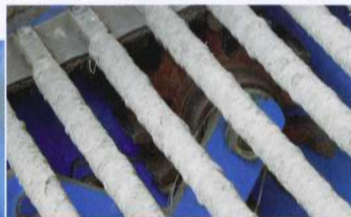
Regulacja stopnia wytrząsania cebuli jest bardzo prosta, ale możliwa tylko na pierwszym z łańcuchów przenoszących.
