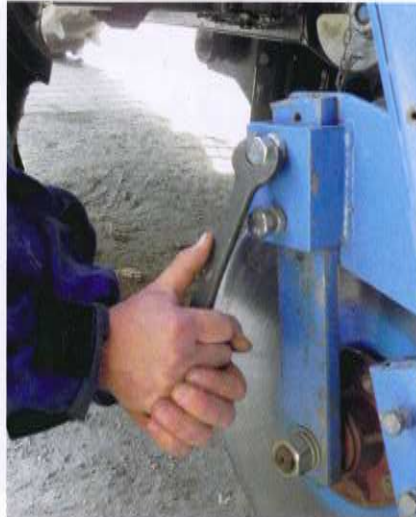
Krój talerzowy reguluje się za pomocą dwóch śrub.
