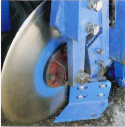
Przedpłuźki umieszczone tuż przy kroju talerzowym zmniejszają zużycie kwadratu kopiącego.
