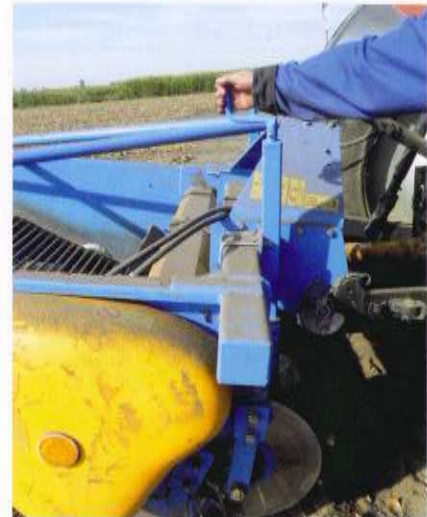
Brak skali do regulacji kół podporowych jest sporym utrudnieniem.
