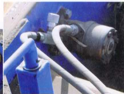
Tzw. wentylator (zdjęcie z lewej) napędzany jest silnikiem hydraulicznym (zdjęcie powyżej) z możliwością regulacji obrotów.
