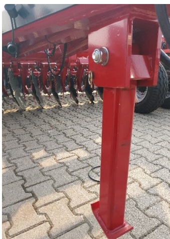
Rys.5. Pozycja postojowa i transportowa wspornika mechanicznego dyszla
