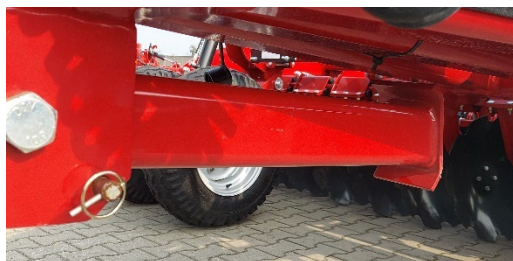
Rys.5. Pozycja postojowa i transportowa wspornika mechanicznego dyszla
