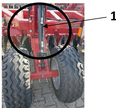
Rys. 8. Regulacja położenia kół podporowych.
