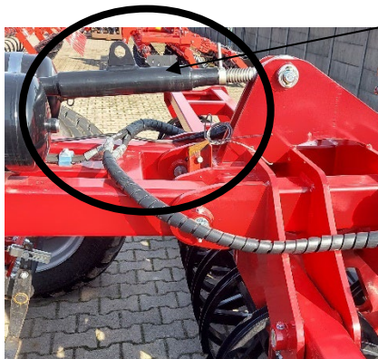
Rys. 9. Regulacja poziomowania wału roboczego.
