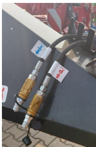
Rysunek 2. Przewody hydrauliczne umocowane prawidłowo.
