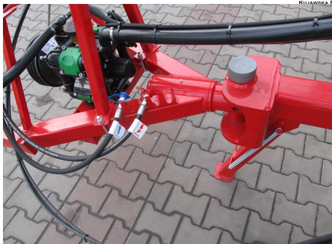
Rysunek 2. Przewody hydrauliczne umocowane prawidłowo.
