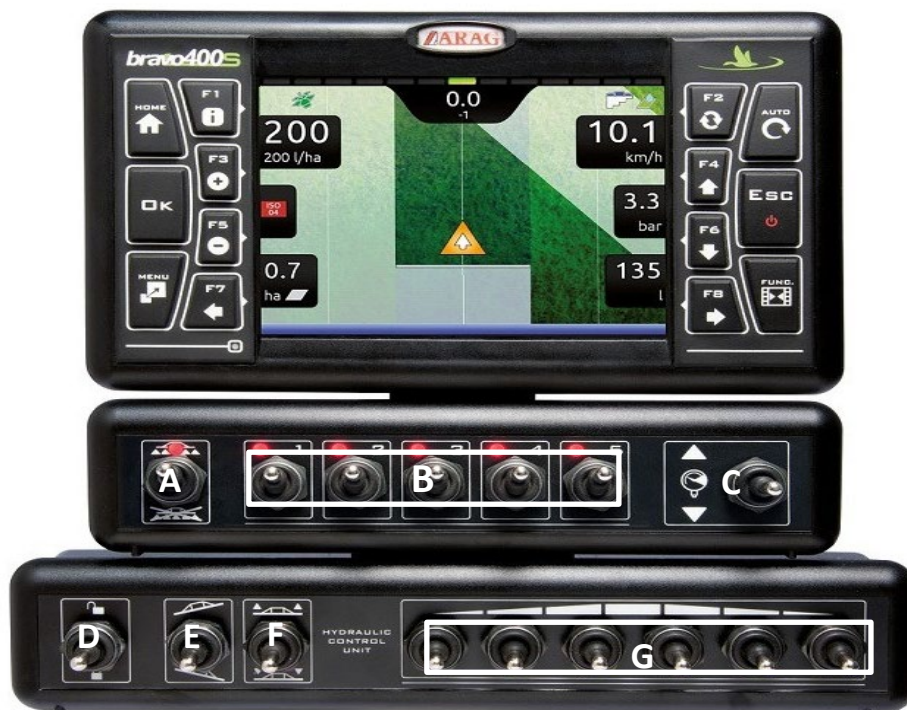
Rysunek 28. Panel sterowania komputera rolniczego BRAVO 400S + hydraulika.
