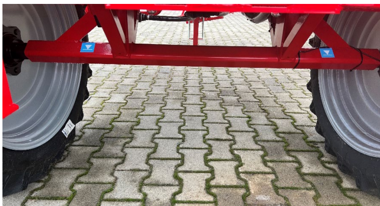
Rysunek 6. Miejsce w którym należy zastosować urządzenie podnoszące.
