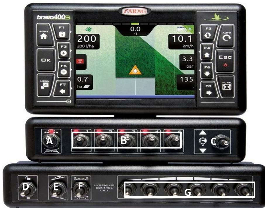
Rysunek 27. Panel sterowania komputera rolniczego BRAVO 400S + hydraulika.
