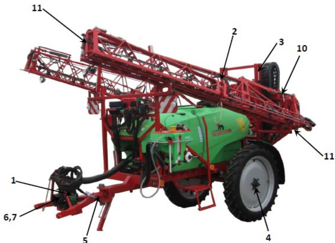
Rysunek 33. Punkty smarowania opryskiwacza APOLLO PHB.
