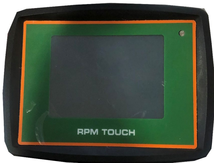
Rysunek 36. Panel obsługowy wentylatora pomocniczego strumienia powietrza.
