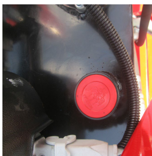
Rysunek 34. Korek wlewu oleju.
