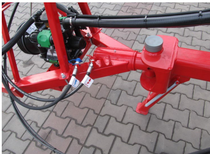
Rysunek 2. Przewody hydrauliczne umocowane prawidłowo.
