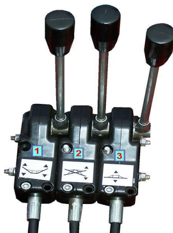
Rysunek 8. Dźwignie sterowania hydrauliką
