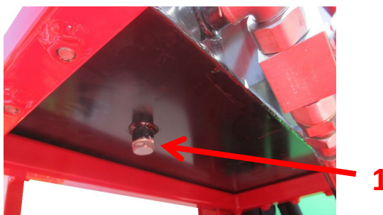
Rysunek 33. Miejsce lokalizacji otworu spustowego w zbiorniku olejowym. 1. Nakrętka otworu spustowego.
