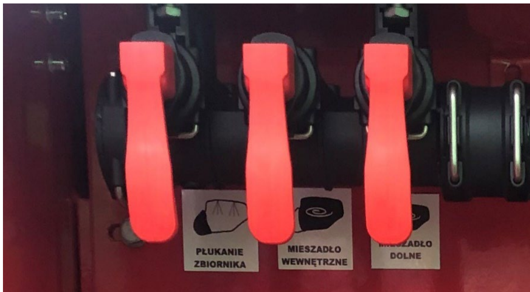
Rysunek 14. Manualne zawory sekcyjne.
