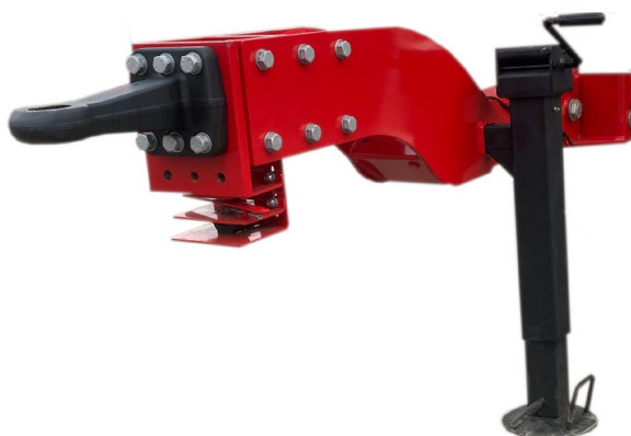
Rysunek 28. Pozycja postojowa wspornika mechanicznego dyszla
