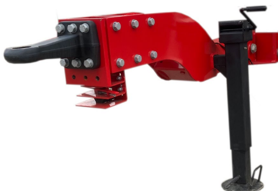
Rysunek 26. Pozycja postojowa wspornika mechanicznego dyszla
