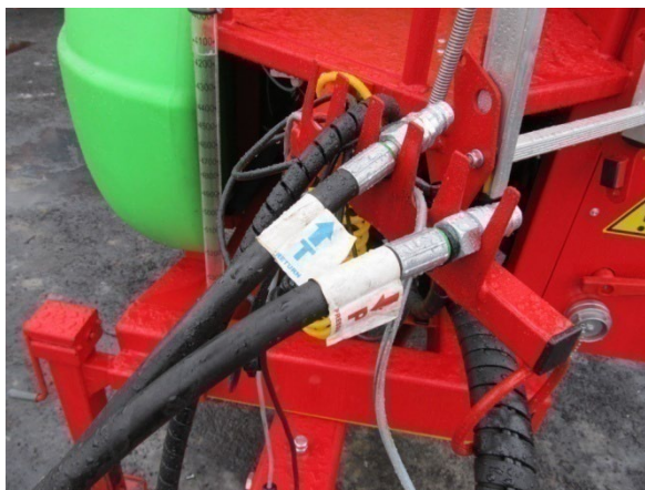
Rysunek 2. Przewody hydrauliczne umocowane prawidłowo.
