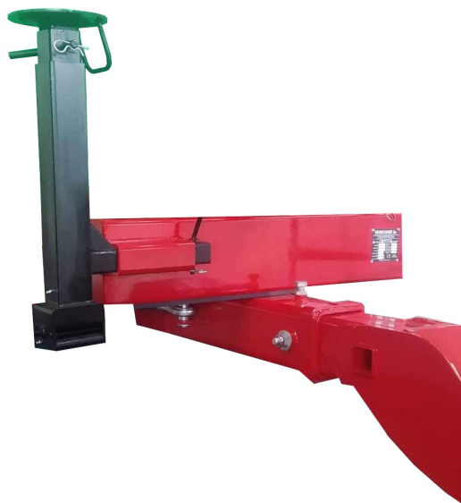
Rysunek 5. Pozycja transportowa wspornika mechanicznego dyszla
