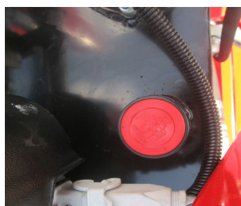
Rysunek 34. Korek wlewu oleju.
