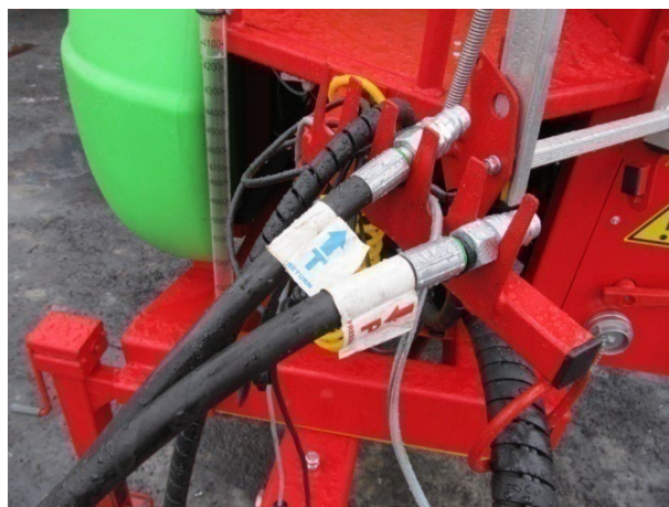
Rysunek 2. Przewody hydrauliczne umocowane prawidłowo.
