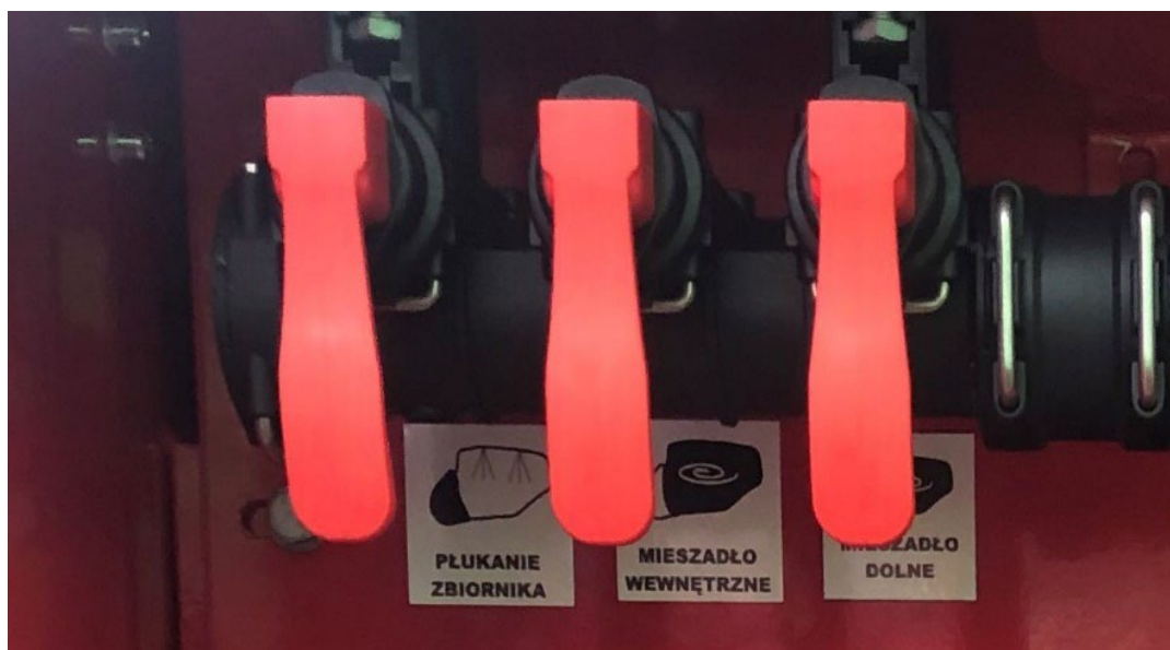
Rysunek 13. Manualne zawory sekcyjne.
