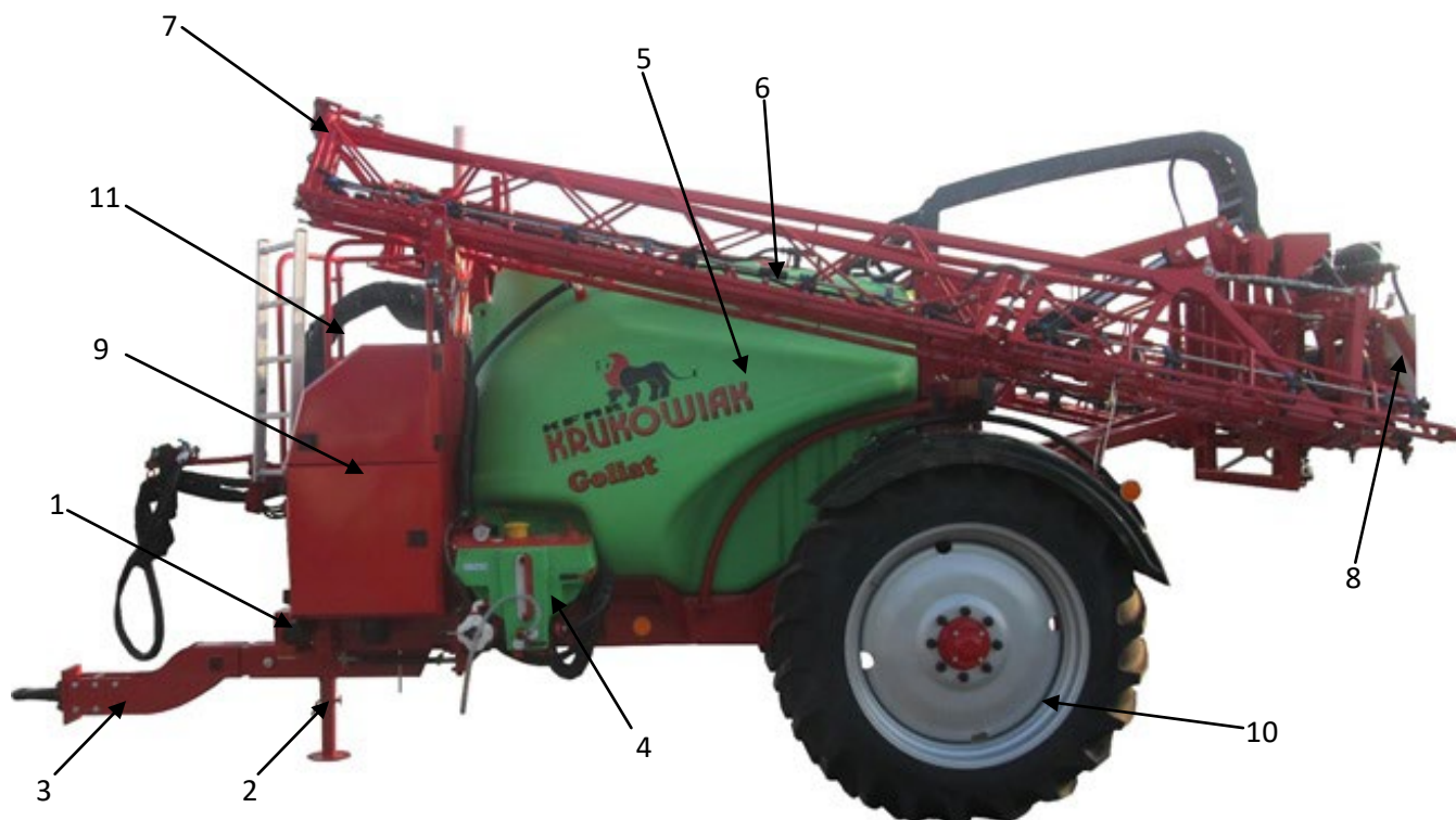
Rysunek 8. Budowa opryskiwaczy GOLIAT 2500/3000/3600/4200 PHN.
