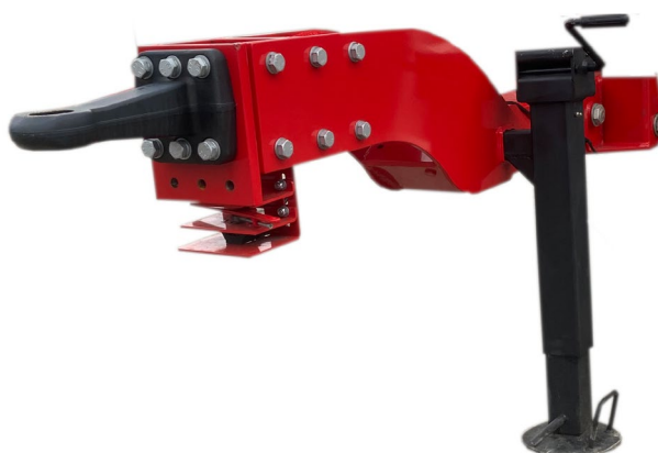
Rysunek 25. Pozycja postojowa wspornika mechanicznego dyszla
