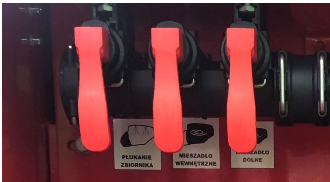
Rysunek 14. Manualne zawory sekcyjne.
