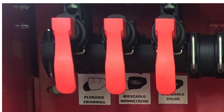
Rysunek 13. Manualne zawory sekcyjne.
