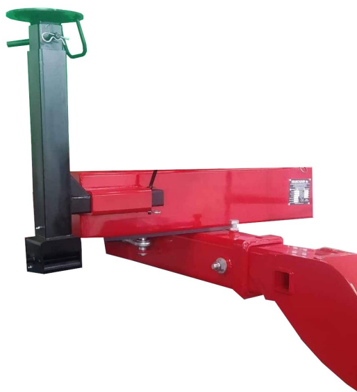
Rysunek 5. Pozycja transportowa wspornika mechanicznego dyszla
