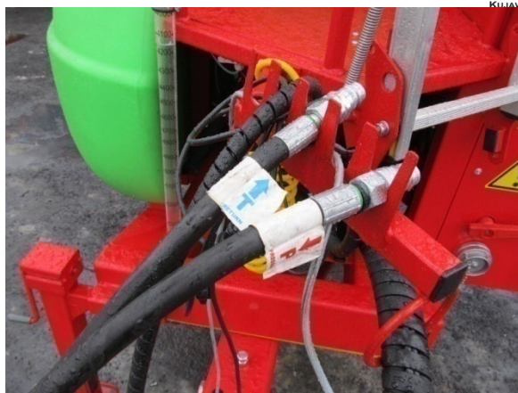
Rysunek 2. Przewody hydrauliczne umocowane prawidłowo.
