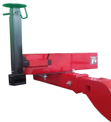
Rysunek 5. Pozycja transportowa wspornika mechanicznego dyszla
