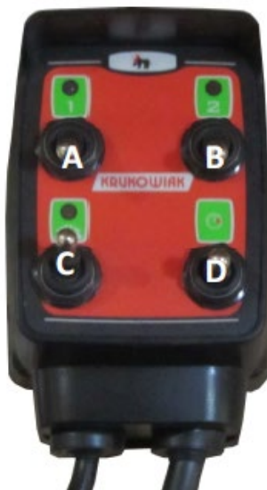
Rysunek 18 Panel sterowania układem cieczowym opryskiwacza.
