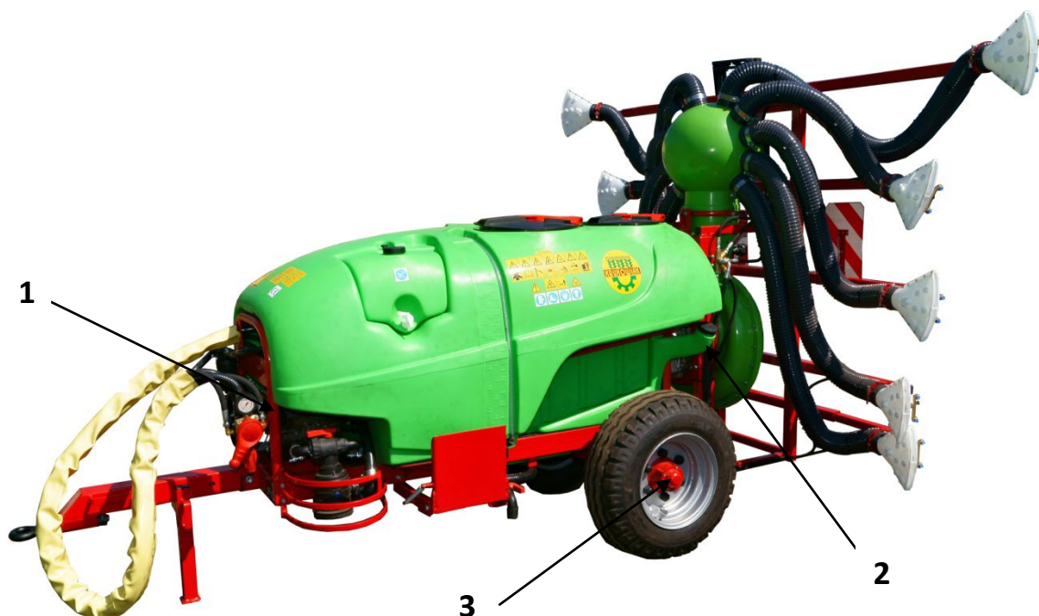
Rysunek 23. Punkty smarowania opryskiwacza OCTOPUS.
