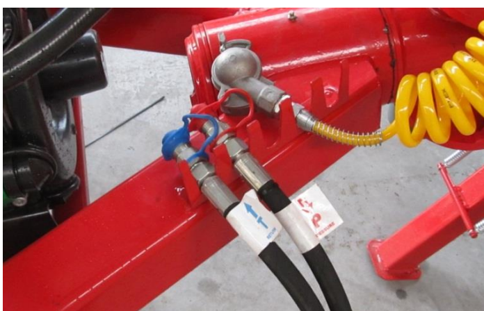
Rysunek 2 Przewody hydrauliczne umocowane prawidłowo.
