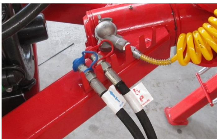
Rysunek 2 Przewody hydrauliczne umocowane prawidłowo.
