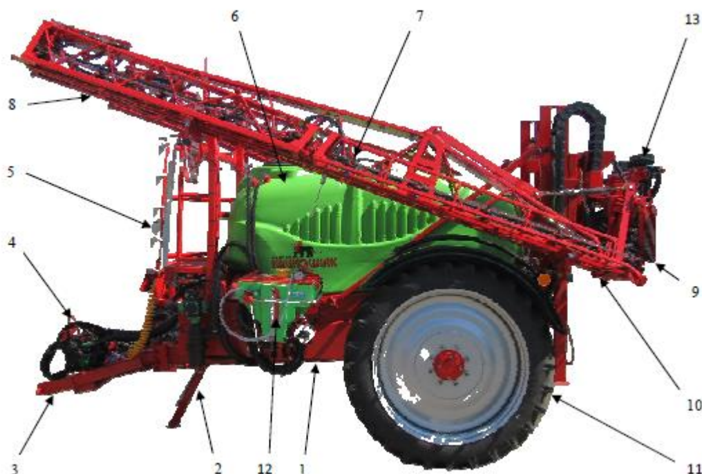
Rysunek 5. Budowa opryskiwaczy ORION 2500/3000 PHB.
