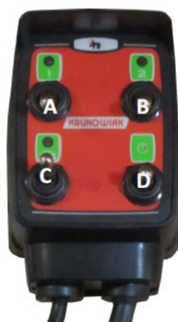
Rysunek 16. Panel sterowania układem cieczowym opryskiwacza.
