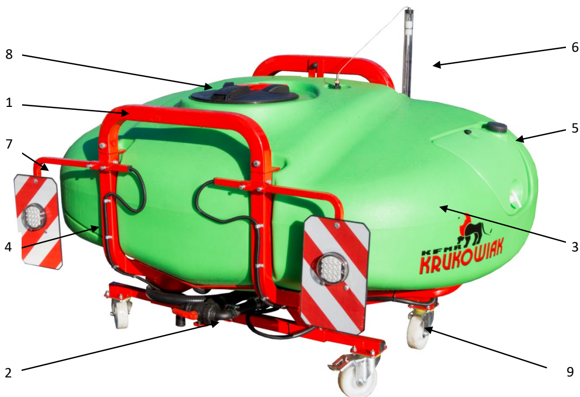
Rysunek 2. Budowa zbiornika czołowego
